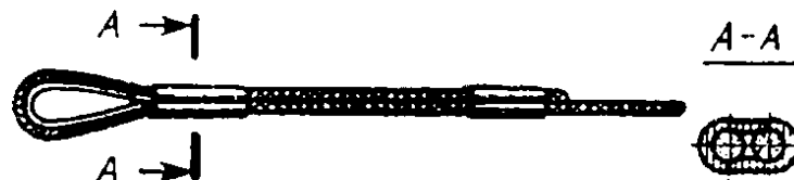
Рис. 101. Заделка тросов обжатием трубочек
