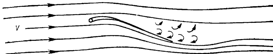
Рис. 31. Срыв потока на больших углах атаки
