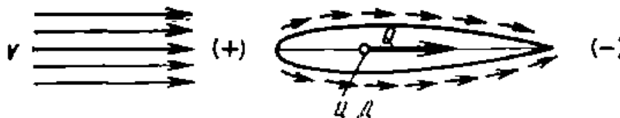
Рис. 19. К возникновению профильного сопротивления
